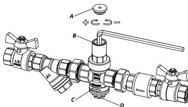
**7.1.** Перед началом монтажа откройте все спускные/дренажные краны, чтобы очистить систему и удалить оставшийся в трубопроводе воздух.
