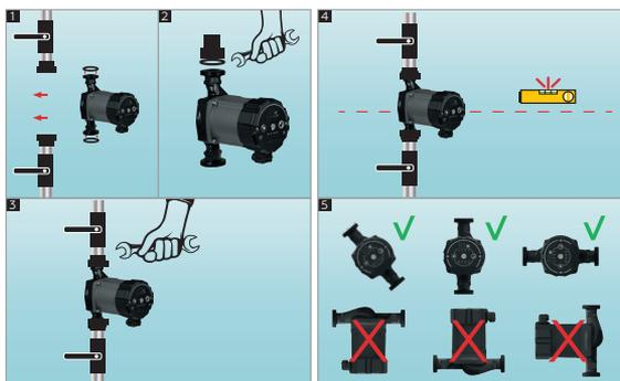
Направление стрелки на корпусе насоса должно совпадать с предполагаемым направлением движения перемещаемой среды.
